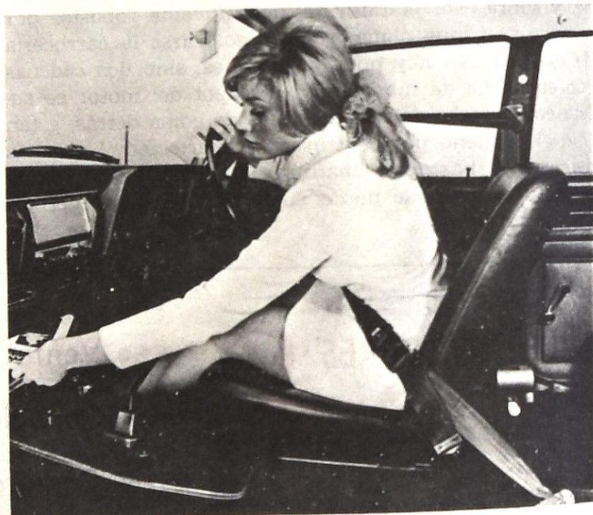
Uno de los dispositivos bloca (progresivamente) la cinta en función del comportamiento del coche: en caso de impacto, patinazo, frenazo violento, etc., con lo que el tirón queda amortiguado. El otro permite, con una recuperación posterior, que la cinta ceda cuando el conductor o pasajero se mueven, como en el ejemplo de la fotografía. El rollo de cinta «de reserva», junto con el sistema de bloqueo, va alojado en un receptáculo cerrado (abajo a la derecha).
