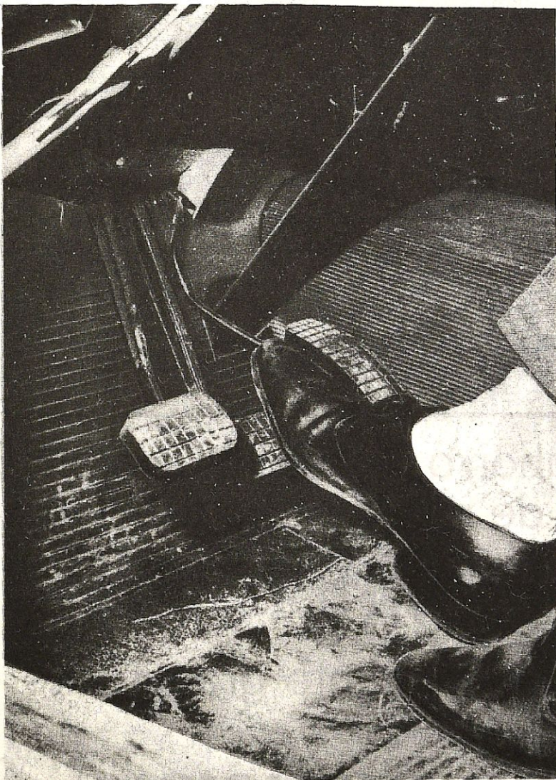
Estas dos fotografías ilustran los dos dispositivos de pedales que se encuentran habitualmente en los coches modernos, arriba sobre un Alfa Romeo Giulia, aparecen pedales clásicos, mientras que abajo el Peugeot 404 lleva los pedales suspendidos.
