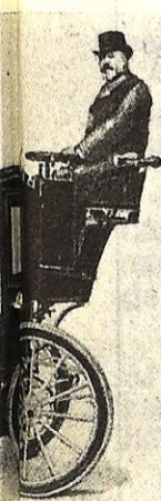
1: Uno de los carteles de la exposición de 1888. —2: Auténtico precursor de la calesa de vapor. —3: Joseph Guedon arquitecto naval, concibió este cuatriciclo para tres personas. Motor de dos cilindros a gasolina. Velocidad anunciada de 8 a 30 kilómetros hora. —4: Animado por Emilio Mors este cuatriciclo para tres personas. Motor de dos cilindros a gasolina. Velocidad anunciada de 8 a 30 kilómetros hora. —5: El conde De Dion al se constituye una sociedad que lanza al mercado este cuatro plazas con un motor de seis caballos y 4 cilindros inclinados. —6: Especialista del vehículo eléctrico, Krieger presenta su «coupé» tres plazas volante de su triciclo a petróleo que se distinguió por su ligereza. —7: El concurso de fiacres-automóviles vió evolucionar a este artefacto eléctrico de dos piezas con neumáticos con velocidad de 25 kilómetros. —8: Antecesor del velomotor, esta bicicleta a petróleo de Dion-Bouton posee un motor monocilíndrico. —9: Revolucionario en su concepción, el motor monocilíndrico de Dion-Bouton con refrigeración por aire es concebido en 1895. —10: La refrigeración por agua del mismo motor data desde 1898. —11: Antes de lanzarse a la carretera, era necesario visitar la colección de pellizas reversibles y de abrigos de piel que se exhibían en casa Storm, especializados en prendas para automovilistas.
