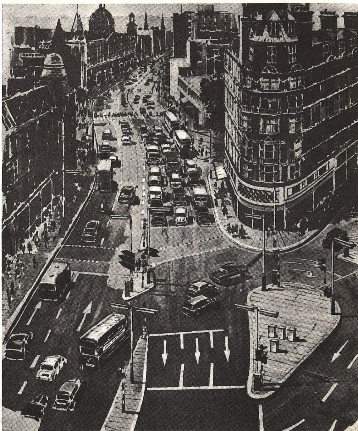
Uno de los cruces de mayor tráfico, de los 68 controlados, es el de Knightsbridge, donde una cámara de televisión montada en el tejado del hotel Hyde Park vigila constantemente. En tierra, los detectores enterrados bajo el pavimento señalarán los retrasos. Los aparatos (algunos de los cuales pueden verse en la isla refugio, a la derecha) no son voluminosos.
