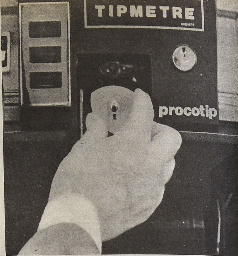
La cámara oculta filma la llave numerada en el momento de la puesta en marcha. Al retirar el llavero, el aparato de fotos registra la hora, la distancia recorrida y el número que identifica al conductor.
