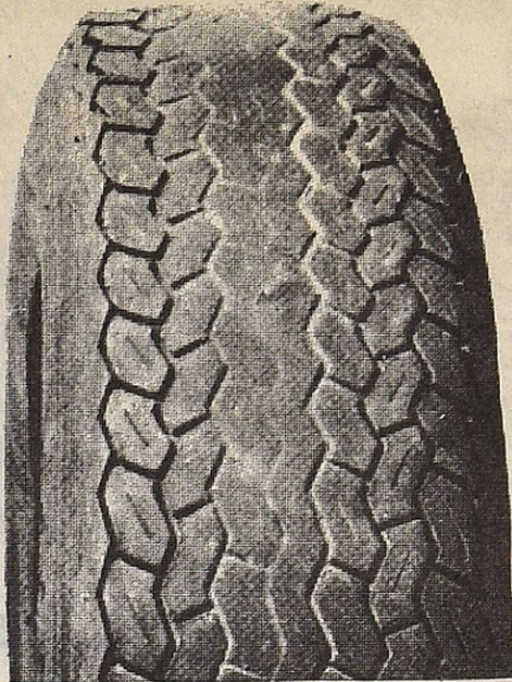
Desgaste desigual - El grado de desgaste de la banda es desigual y pasa de un máximo a un mínimo. Causas: Montaje excéntrico de la cubierta sobre la llanta. Remedio: Equilibrar la rueda y el neumático.
