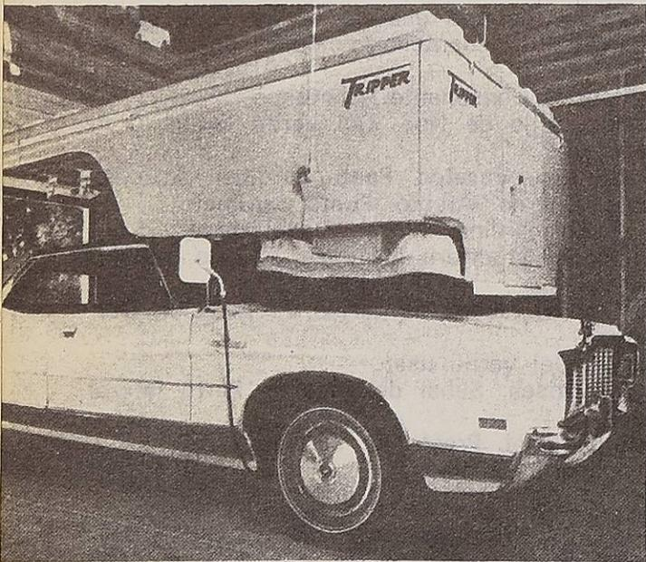
Cuando no se utiliza la habitación transportable, puede suspenderse del techo del garaje, con lo que no ocupa lugar alguno, y queda de forma que después puede montarse sin ningún esfuerzo.
