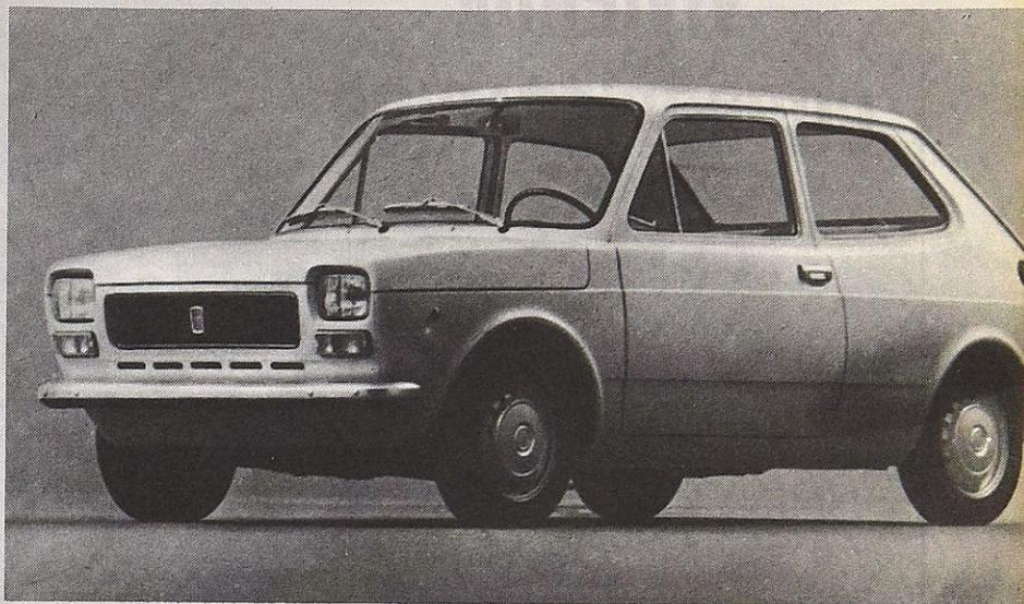
Se ha presentado en Turín el último modelo de la gama Fiat, el 127. Se trata de un tracción delantera, con un motor de 903 c.c., que arroja una potencia de 47 CV. DIN. Más adelante informaremos a nuestros lectores sobre el nuevo vehículo, ofreciéndoles una prueba resumida efectuada por nuestro enviado especial en la localidad italiana.
